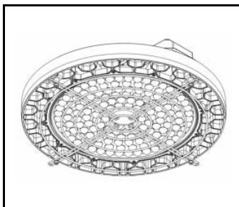
OCULUS LED - Bausatz Sicherheitsnetz (561382)
