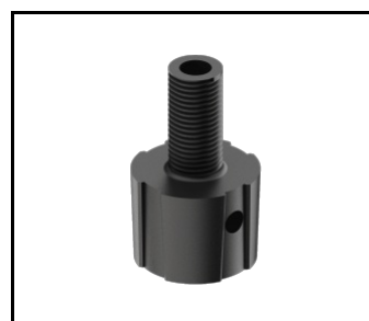
SKVER R vnější závit adaptéru M20x40 (rozteč 2,5) (804427)
