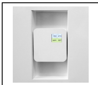
CO2 sensor - Sterilon Max Pro
